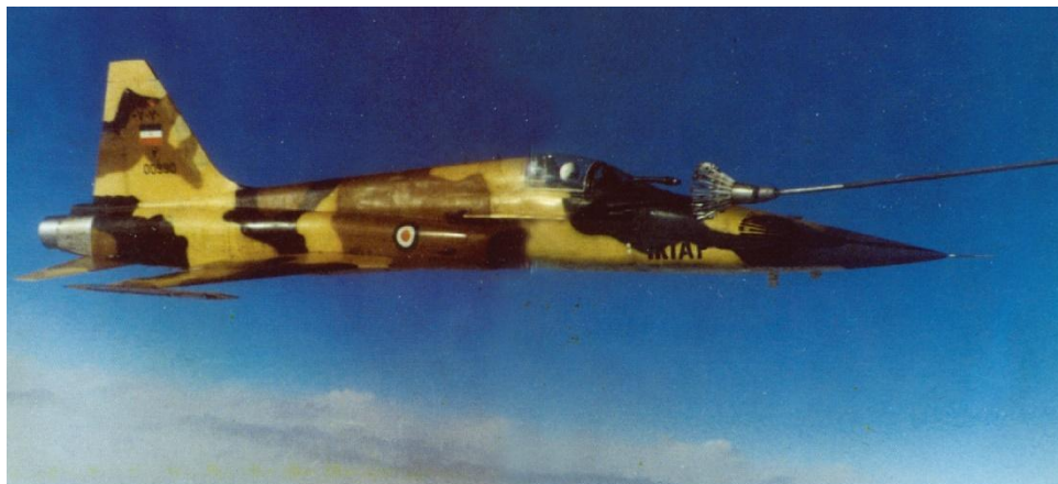
تبدیل هواپیمای اف-۵ به نوعی که قابلیت سوختگیری در هوا را داشت.
