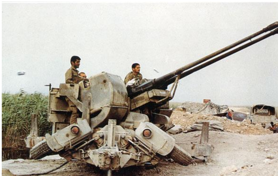
یک عراده توپ ۳۵ میلی‌متری اورلیکن (زمین به هوای راداری) که در عملیات فتح‌المبین به همراه سایت موشکی هاوک به منطقه گسترش یافت
