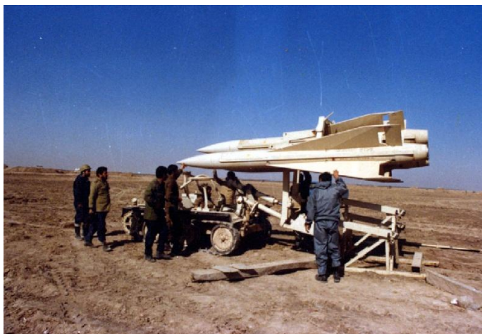
گسترش آتشبار موشک زمین به هوای هاوک. این نوع موشک و سایت آن متحرک نبود و برای گسترش در مناطق نبرد زمینی تناسب نداشت.
