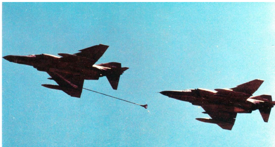
سوختگیری و سوخت‌رسانی دو فروند هواپیمای فانتوم در آسمان از ابتکارات و پروژه‌های نیل به خودکفایی در نه‌جا بود (BODY REFUELING)
