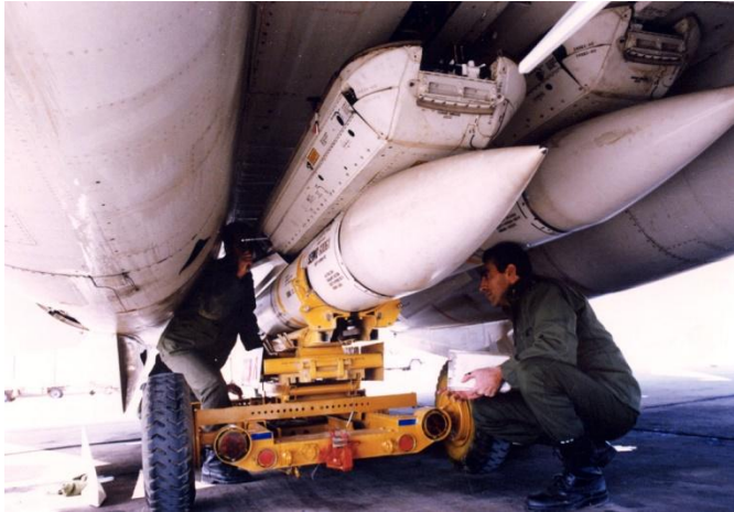
کارکنان فنی نیروی هوایی در حال نصب موشک‌های دوربرد فنی‌کس زیر بال و بدنه هواپیمای
