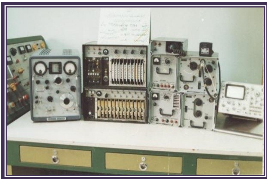
نمای داخلی رادیو ترمینال TRC145 جهت ارتباطات چند چانلی مورد استفاده در باند UHF
