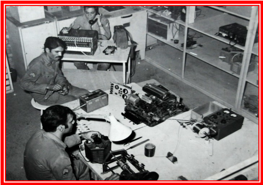
رزمندگان تعمیرکار ارتش در حال تعمیر تجهیزات ارتباطی در دفاع مقدس
