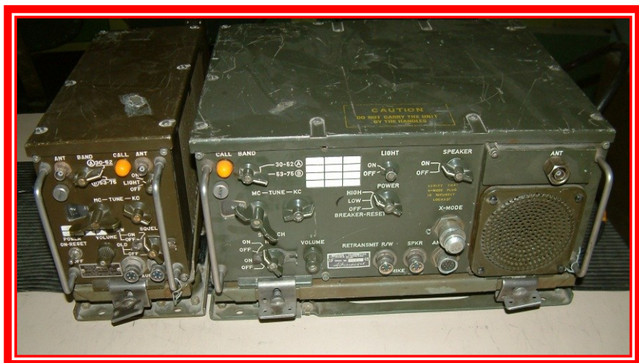
بی سیم AN-VRC 12 در باند فرکانسی VHF
