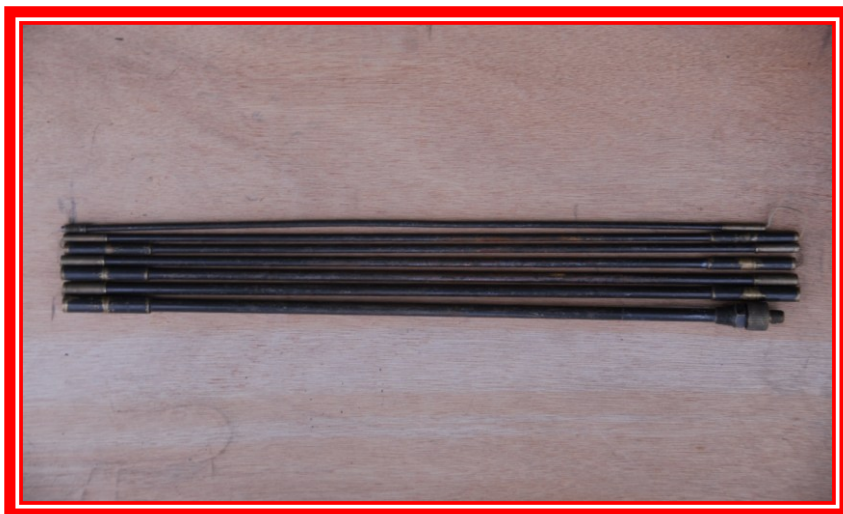
آنتن هفت قسمتی میله‌ای AT-271 مخصوص بی سیم PRC 77
