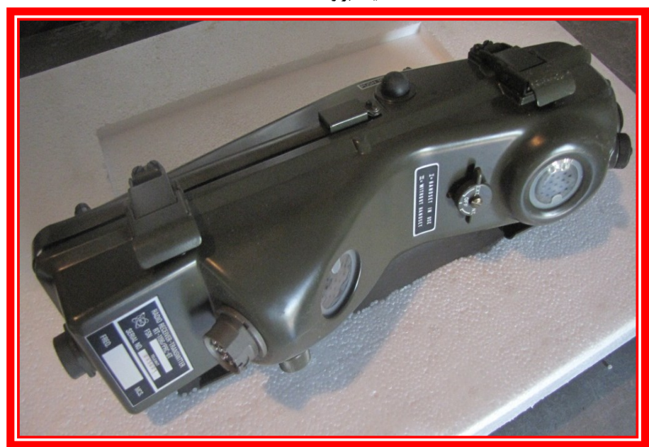
بی سیم دستی PRC 6 در باند فرکانسی VHF
