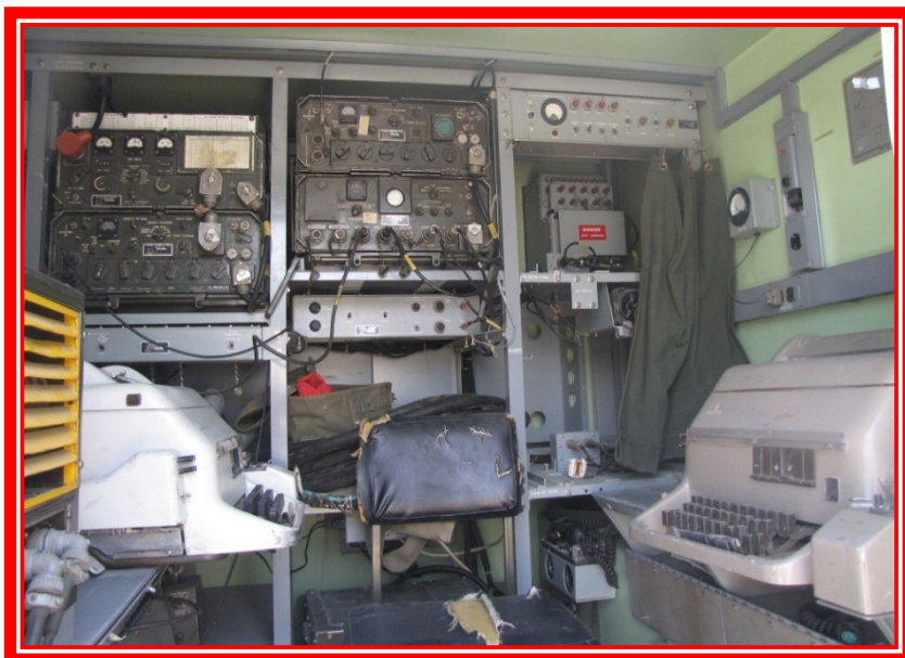
نمای داخلی بی سیم GRC 122 جهت ارتباطات تله تایپی مورد استفاده در باند فرکانسی HF
