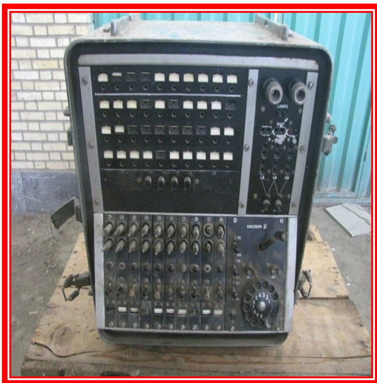
مرکز تلفن صحرایی ABM1016 مورد استفاده از تیپ په بالا در دفاع مقدس
