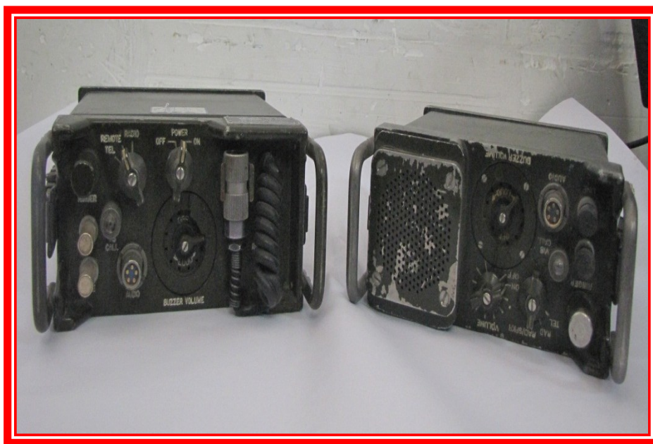
کنترل گروپ 39-GRA مورد استفاده در باند فرکانسی VHF
