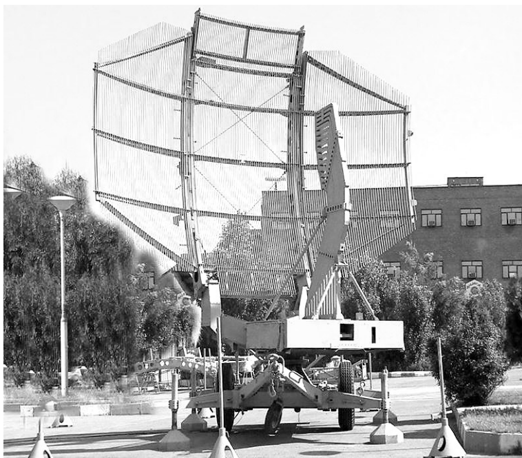
آنتن رادار ملی پس از مونتاژ کامل و گسترش یافته جهت انجام تست‌های فنی و عملیاتی
