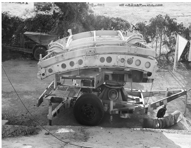
آنتن رادار ملی در حالت جمع‌آوری شده جهت جابه‌جایی و حمل و نقل
