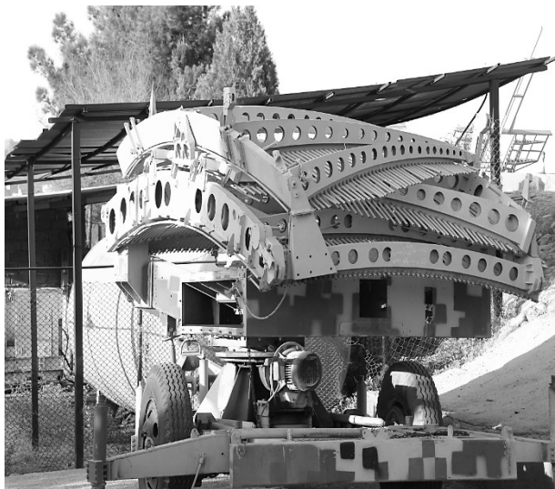
آنتن رادار ملی در حالتی که رفلکتورهای آن بسته شده است
