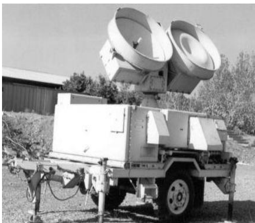
رادار تعقیب کننده هدف سامانه هاگ
